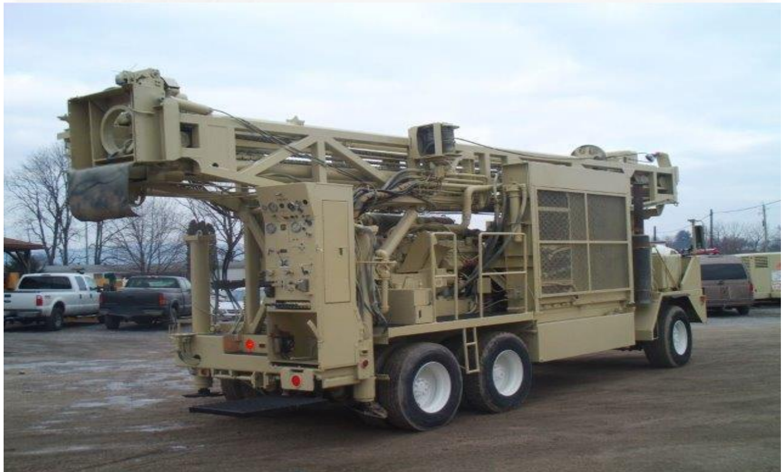
RIG 2- INGERSOLL-RAND T4W DH DRILL RIG
